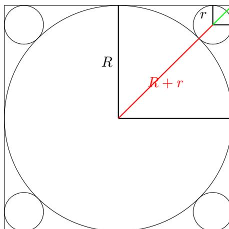
Ist  $R = 1$  der Radius des großen Kreises und  $r$  der Radius des kleinen Kreises, hat die rote Strecke in der Skizze die Länge  $R + r$ , die grüne Strecke in der Skizze die Länge  $\sqrt{2}r$  und beide Strecken zusammen die Länge  $\sqrt{2}R$ .
